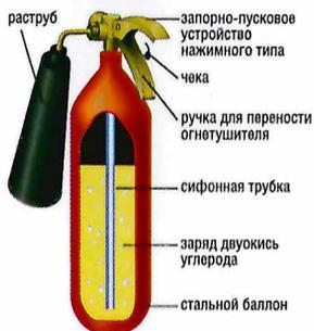
Устройство с зарядом двуокиси углерода (CO<sub>2</sub>) сжиженной, это позволяет снизить температуру и вытеснить кислород в месте возгорания. Углекислотные огнетушители используют для тушения следующих классов пожаров:
